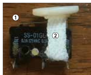
図4 対象児の母親に提案した操作スイッチ ①ヒンジレバー ②耳掛け部のゴム
